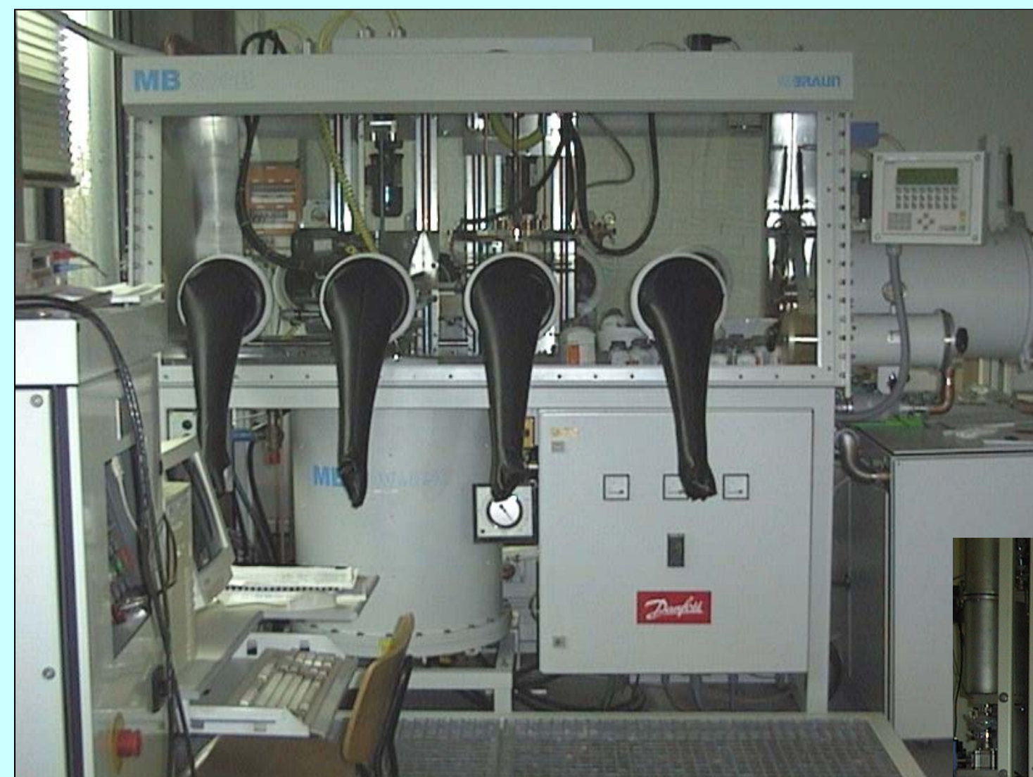
Udstyr til tantalbelægning ved elektrolyse i fluoridsmeltebad, \text{LiF-NaF-KF-K}_2\text{TaF}_7
